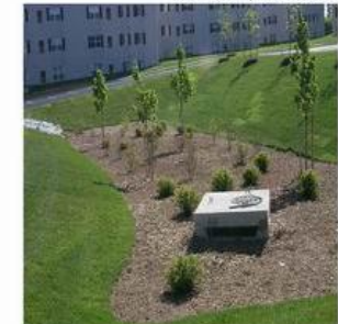
חצר אופייני דרך אגני ההחדרה, הצמחיה משמשת להאט הזרימה ולטיהור המים
